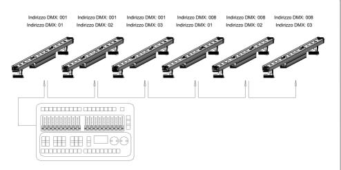
Selezionare il canale **STAG** sul pannello di controllo del dispositivo (fare riferimento a Selezione Canali DMX512).
