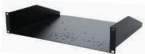
**ADRK2AZ** - Ripiano a 2 unità rack da 19" realizzato con lamiera in acciaio da 1,5 mm di spessore con foratura universale per l'alloggiamento di apparecchiature sprovviste di attacco rack. Profondità utile 371 mm. Confezione standard: 6 pezzi.
