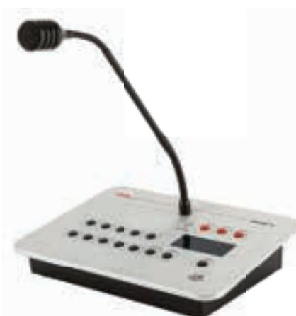
**EV BME10T** - Consolle microfonica completamente monitorata secondo normativa EN54-16. Corpo in alluminio estruso, completa di microfono gooseneck dinamico. Tastiera numerica a 10 tasti, tasto "Clear", tasto MUSIC, Tasto "Talk" e tre tasti per l'attivazione dei messaggi MSG1-MSG2-MSG3, Led "Busy" e "System", display LCD. Tutte le funzioni dei tasti sono programmabili da software. Alimentazione tramite cavo RJ45 (3 metri incluso) da centrale o tramite alimentatore locale non fornito.
