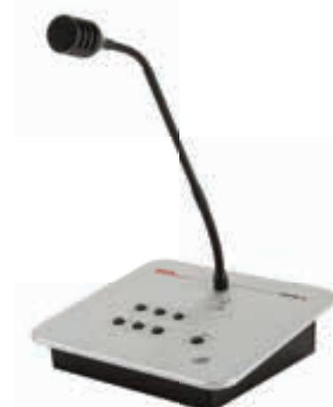
**EV BME6T** - Consolle microfonica completamente monitorata secondo normativa EN54-16. Corpo in alluminio estruso, completa di microfono gooseneck dinamico. 6 tasti e tasto di "Talk" completamente programmabili da software, led "Busy" e "System". Alimentazione tramite cavo RJ45 (3 metri incluso) da centrale o tramite alimentatore locale non fornito.
