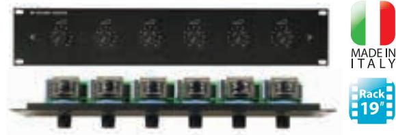
**ZVC06** - Questo pannello Rack 19" è un regolatore di volume multiplo per n° 6 linee a 100V, con 100W di carico massimo ciascuna. E' dotato di n° 6 attenuatori, ciascuno fornito del proprio relè di bypass a 24Vdc.
