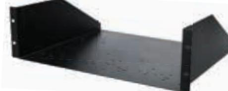
**ADRK3AZ** - Ripiano a 3 unità rack da 19" realizzato con lamiera in acciaio da 1,5 mm di spessore con foratura universale per l'alloggiamento di apparecchiature sprovviste di attacco rack. Profondità utile 371 mm. Confezione standard: 4 pezzi.
