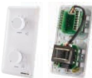
**S6VR12** - Selettore di 6 programmi PA con attenuatore di volume ad incasso su 11 posizioni per linee a 100V. Trasformatore da 12W per incasso su scatola dedicata. Completo con relè bypass 24Vdc.
